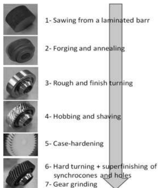
Figure 1.6 : Etapes de fabrication d'un cône de synchronisateur.
