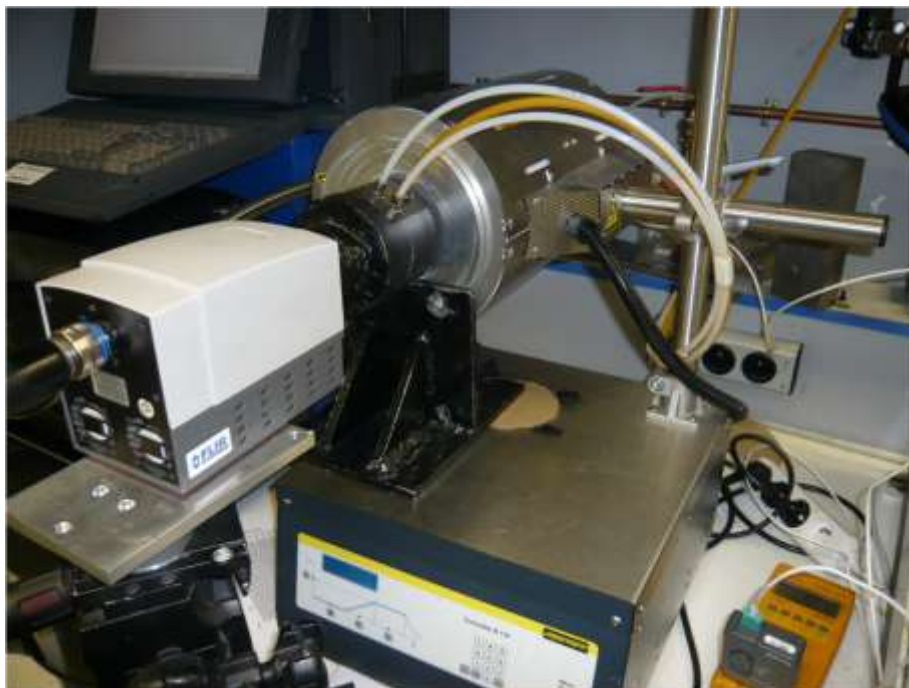
Figure B.6: Mesure de rayonnement en cours sur le barreau en inox 316L.
