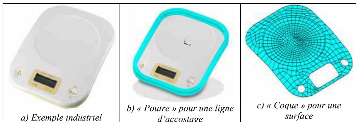
Figure 4.5 Modèle « poutre » ou modèle « coque »
