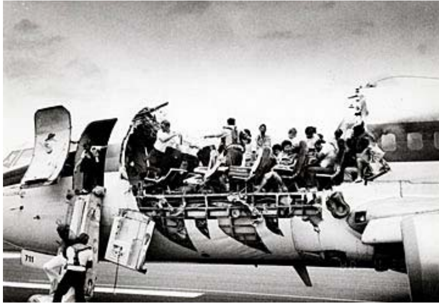
Figure 1 : Accident de l'Aloha Airlines en 1988, sur un Boeing 737 assurant des vols régionaux entre Hilo et Honolulu, après 19 ans de service, 35493 heures de vols et 89090 cycles de vol.
