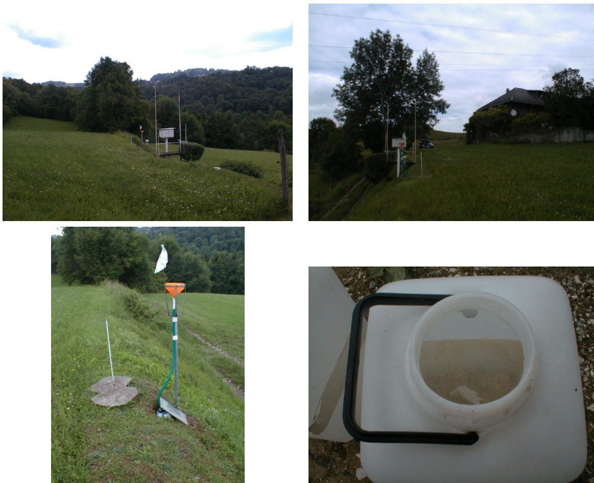
Figure 3.3: Photos du système d'échantillonnage des précipitations mensuelles à la station d'Etercy (512 m). (haut gauche) Vue d'ensemble de la station en direction du sud. (haut droit) Vue d'ensemble de la station en direction du nord. (bas gauche) Système de récolte des précipitations liquides (entonnoir, tuyau et bidon enterré à droite) et des précipitations solides (planche à gauche). (bas droit) Bidon de 10 litres avec couche de vaseline flottant sur précipitations.
