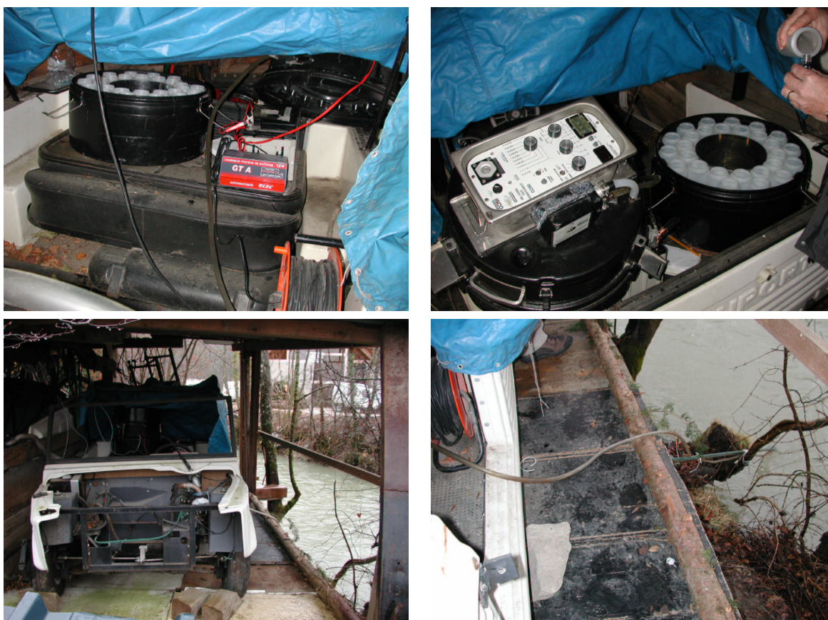
Figure 3.11: Photos du système d'échantillonnage automatique de l'Eau Morte et de son installation. (haut gauche) Réserve des 28 flacons (gauche), chargeur de batterie, batterie et vue de dessous du système programmable (droite). (haut droit) Vue de dessus du système programmable (gauche) et de la réserve des 28 flacons (droite). (bas gauche) Vue d'ensemble du lieu de stockage de l'échantillonneur automatique. (bas droite) Vue du tuyau de prélèvement.
