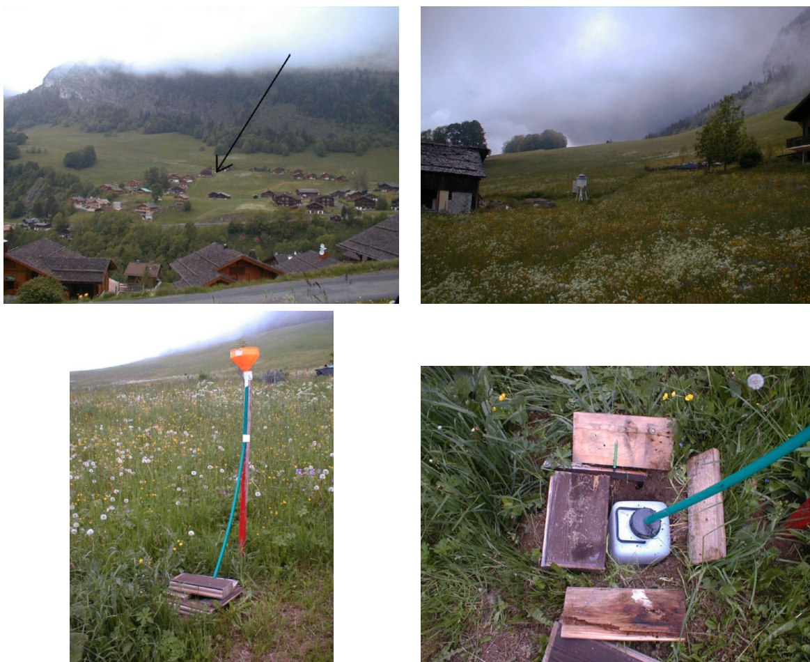
Figure 3.4: Photos du système d'échantillonnage des précipitations mensuelles à la station du Grand-Bornand (1260 m). (haut gauche) Vue d'ensemble de la station en direction du nord. (haut droit) Vue d'ensemble de la station en direction du nord-ouest. (bas gauche) Système de récolte des précipitations liquides (entonnoir et tuyau). (bas droit) Bidon de 10 litres enterré.
