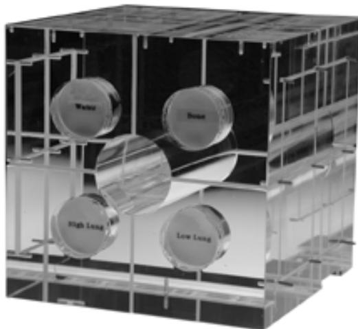
Figure 2.4 – Photographie de l'objet-test physique *ISIS QA-1* [TGM<sup>2</sup>].
