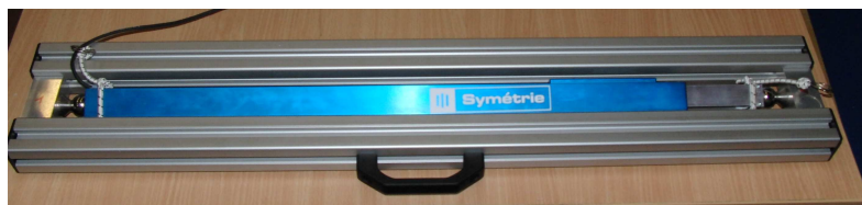
(b) Jambe de la plate-forme de Gough dans l'artefact d'étalonnage
