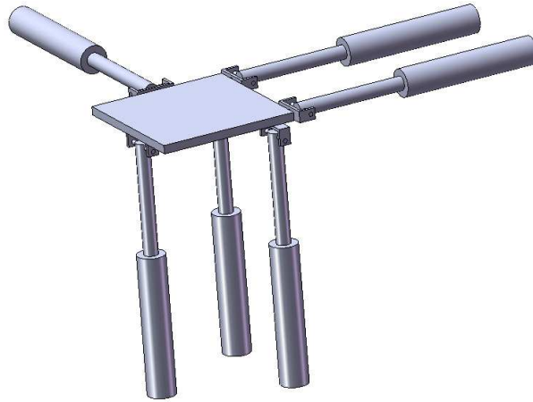
Figure 4.12 - Schéma d'une table de simulation multi-axes
