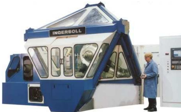
(a) Machine-outil basée sur une plate-forme de Gough (Ingersoll, USA)
