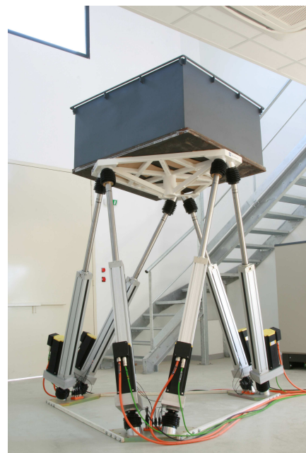
(d) Simulateur de houle (Symétrie, France)
