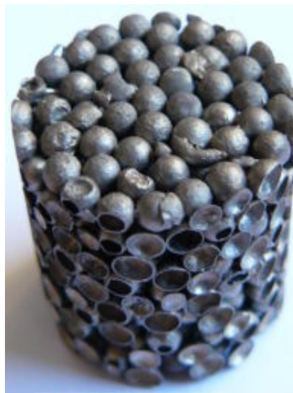
FIG. I-1.3 – Empilement de sphères creuses
