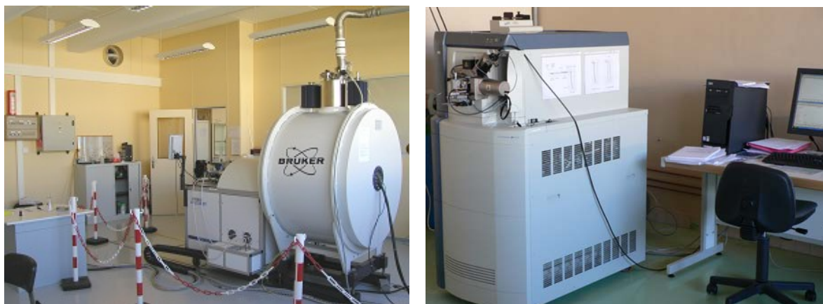
Figure 3-3 : A gauche, spectromètre FT-ICR Bruker BioAPEX III (7 Tesla) du laboratoire DCMR de l'Ecole Polytechnique. A droite, spectromètre QToF-Premier de ce même laboratoire.
