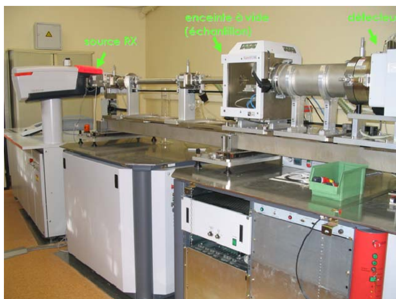
Figure 2-8 : Photo du montage de mesures SAXS de l'IBBMC à Orsay. Des détails supplémentaires sont disponibles à l'adresse http://www.ibbmc.u-psud.fr/ressources/saxs/nanostar.inc.php .
