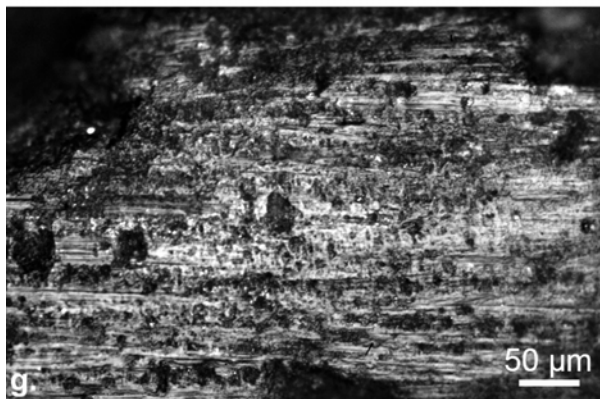
g. et h. Micro-photographies des usures intenses liées au frottement avec un percuteur en quartz
