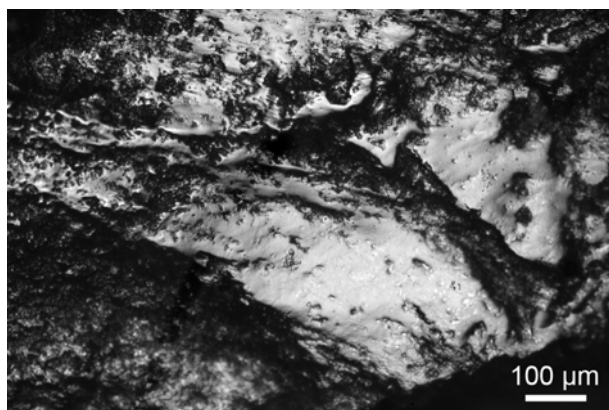
Figure 161. Photographie d'un spot très brillant à coalescence dure ondulée.
