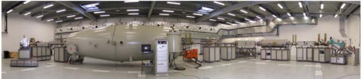
Fig.II.24 : Photo du Spectromètre de Masse par Accélérateur de 5 Millions de volts du CEREGE (d'après http://www.cerege.fr/?masque=inc-service&id_rubrique=27&sous_masque=inc-sitem&id_onglet=-1&id_article=450 ).
