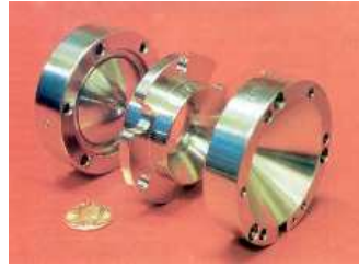
Les trois électrodes de la trappe ionique
