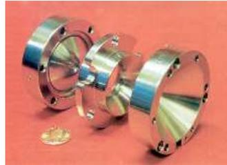
Les trois électrodes de la trappe ionique
