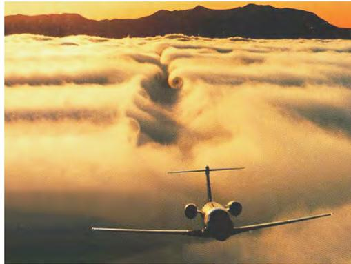
Turbulence générée derrière l'avion.
