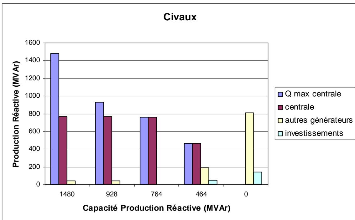
Figure 28 : centrale de Civaux : productions de puissance réactive en fonction de la capacité
