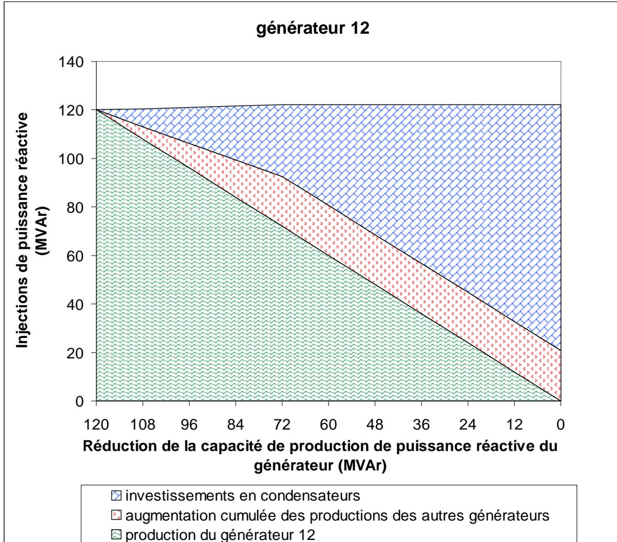
Figure 21 : injections de puissance réactive en remplacement de la production du générateur n°12
