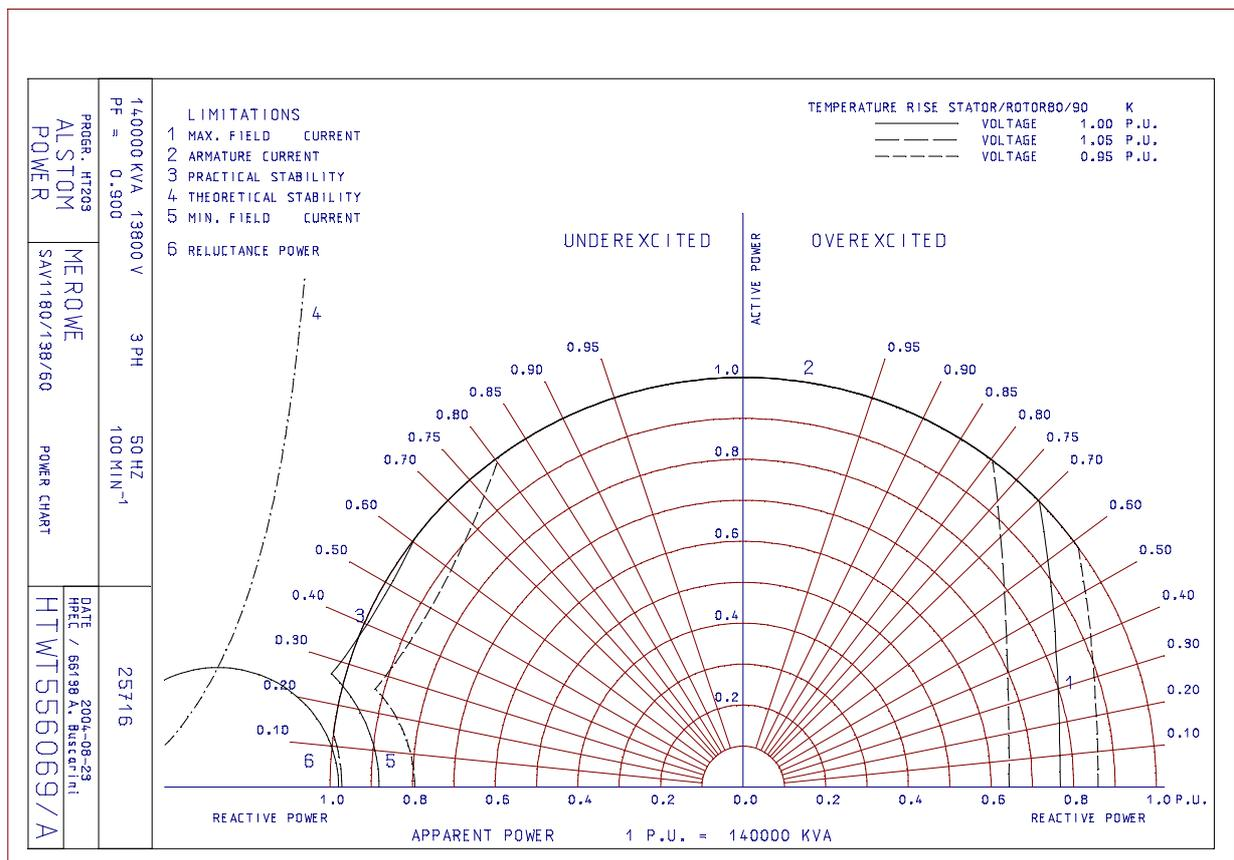
Figure 6 : Diagramme P-Q-U d'un alternateur synchrone
