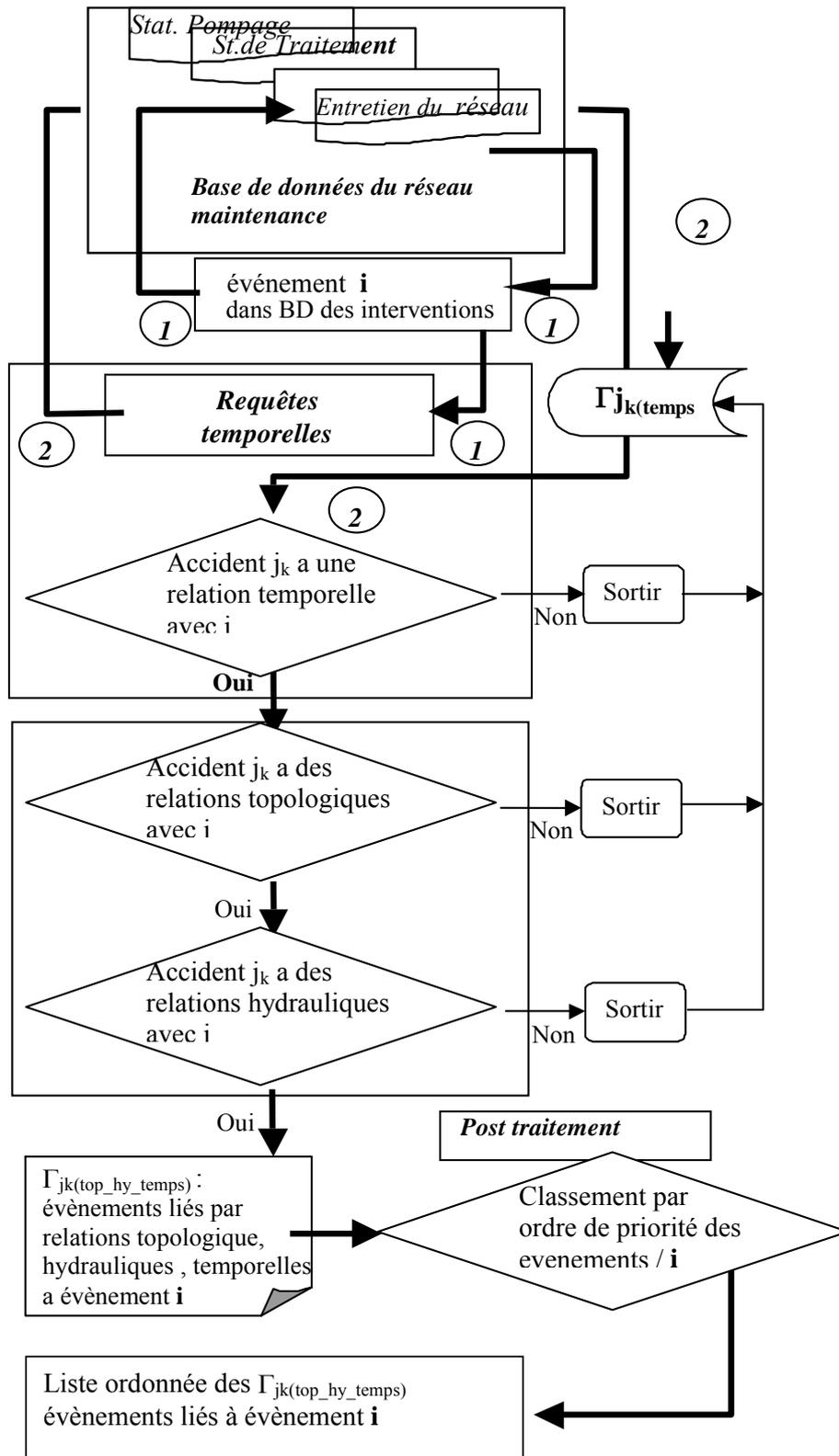
Figure 2.1.3 : Analyse spatio-temporelle : requêtes temporelles et spatiales (topologiques et hydrauliques) (Blindu 2004)
