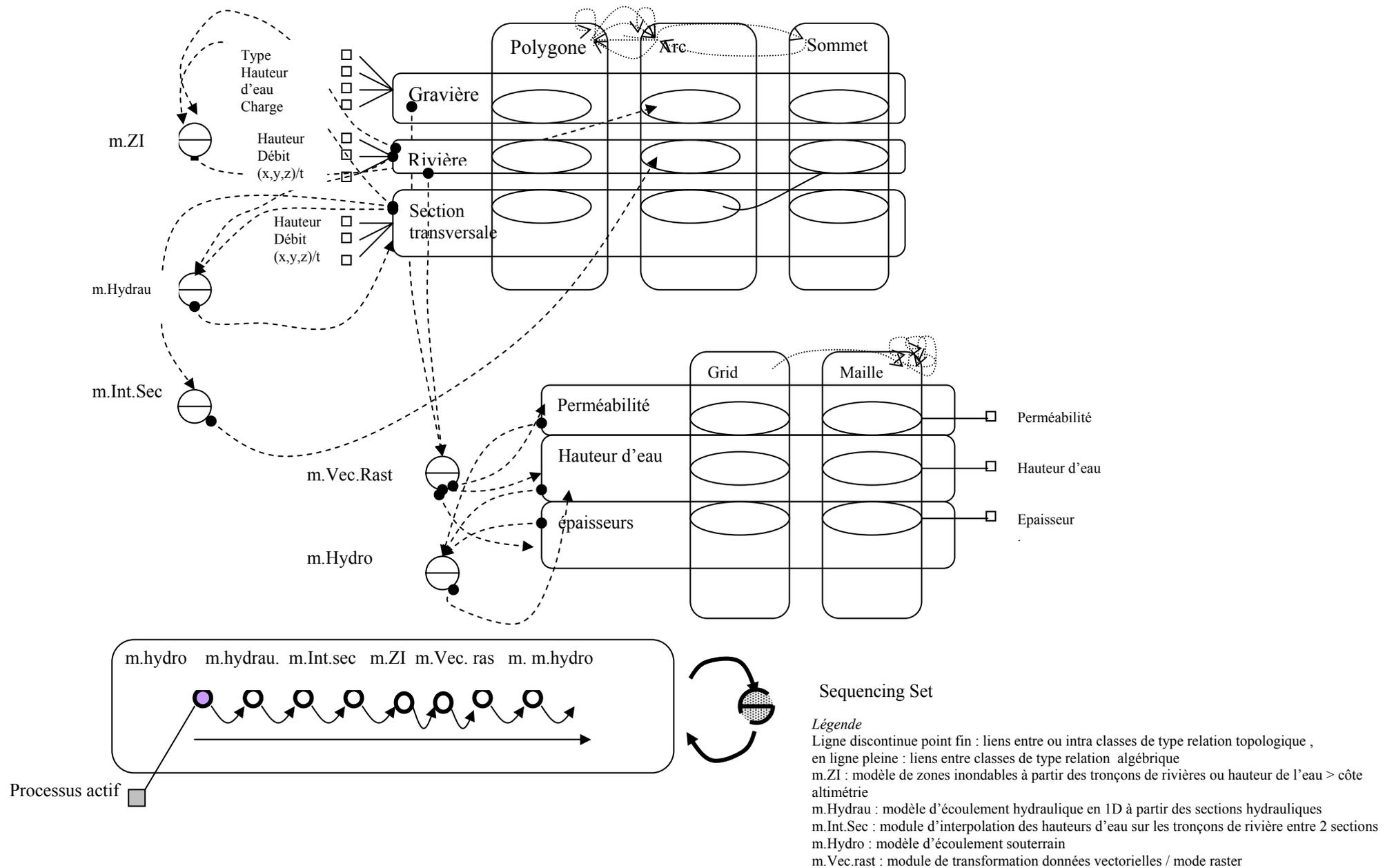
Figure 1.2.7 Interopérabilité pour une modélisation hydraulique et hydrodynamique de type SQS : un ensemble de processus algorithmiques est pris en charge par un gestionnaire de simulation de type SQS, qui entraîne une modification de la structure du modèle de données avec création dynamique ou non d'objets de type arcs, sommets et de leurs topologies, des processus de type codes numériques de calcul des hauteurs d'eau. Exemple de séquence instantanée dans le SQS
