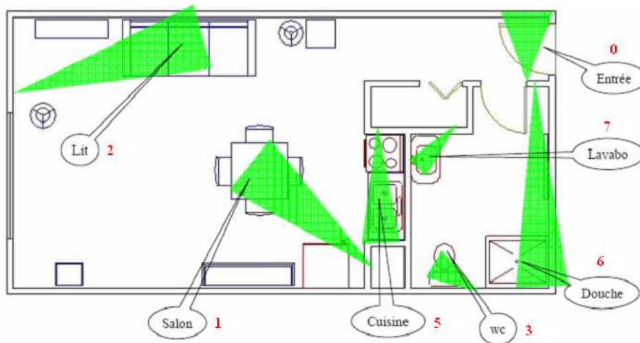
Figure 2-2 - Plan et disposition des capteurs infrarouges de la plateforme AILISA
