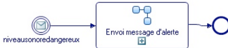
Figure 4.10. Exemple d'utilisation d'un événement contextuel pour déclencher automatiquement le démarrage d'un processus métier dès que celui-ci survient
