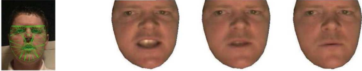
FIG. 2.6 – Modèles de formes et d'apparence : a) le modèle de forme est utilisé pour normaliser les images de la base d'apprentissage ; b) images de synthèse créées à partir du modèle de forme et d'apparence (Theobald et al. , 2003).
