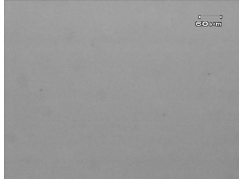
Fig. 3.9 – Photographies au microscope optique d'un film gris de SDBS déposé sur une plaque de verre silanisée. À cette échelle, le film est uniforme et ne semble pas démouiller.
