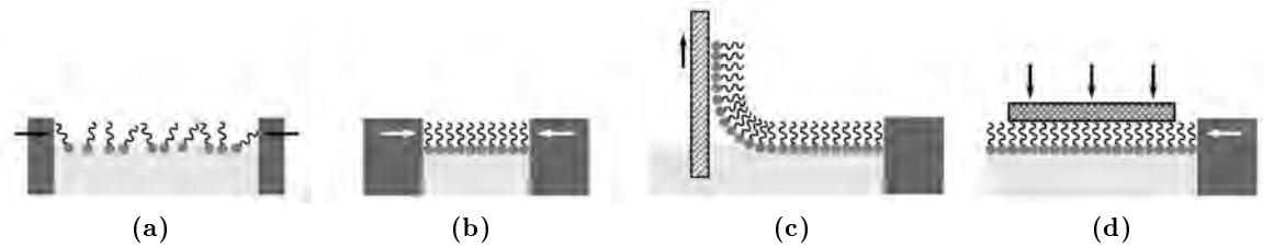
Fig. 2.1 – Principes des méthodes de dépôts de Langmuir-Blodgett et Langmuir Schaefer : (a) formation d'un film de Langmuir à partir de molécules tensioactives (b) compression du film de Langmuir c dépôt du film de Langmuir sur substrat solide par la méthode de Langmuir-Blodgett d dépôt du film de Langmuir sur substrat solide par la méthode de Langmuir-Schaefer.
