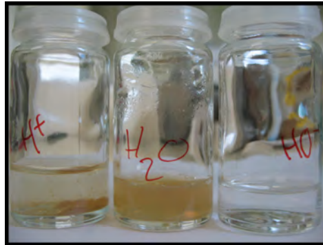
Fig. 4.5 – Influence du pH sur la dispersion des nanocristaux de silicium dans l'eau. Les photographies sont prises 3 heures après la préparation des dispersions. Au centre, à un pH \approx 7 , la suspension semble stable. A gauche, à un pH \approx 1 , les particules s'agrègent. A droite, à un pH \approx 12 , la solution est incolore, les particules ont été entièrement hydrolysées en quelques heures.
