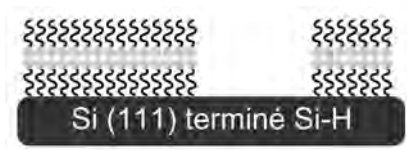
Fig. 2.27 – Schéma d'une bicouche transférée de C_6F_{13} -SOTHAM sur silicium Si(111) gravé par NH_4F . Cette bicouche comporte un "trou" correspondant à une partie de la bicouche qui n'a pas adhéré lors du transfert.
