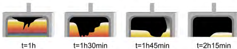
Fig. 1.29 – Schémas du drainage observé d'un film vertical de C_6F_{13} -SOTHAM, C_6F_{13}CH_2CH_2COO^-, Na^+ et AgNO_3 tiré sur un cadre en acier. La solution utilisée pour former le film comporte à la fois des ions Ag^+ et des nanoparticules d'argent. Les inhomogénéités observées lors du drainage sont expliquées par la présence de nanoparticules.
