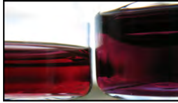
Fig. 5.1 – Photographies illustrant la différence de couleur observée entre une solution de colloïdes d'or parfaitement dispersés (à gauche) de couleur rouge et une solution de colloïdes d'or agrégés (à droite) de couleur violette.
