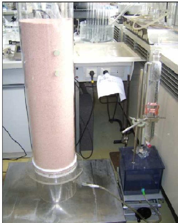
Figure 7-1 : Dispositif expérimental d'obtention de la courbe de rétention d'eau
