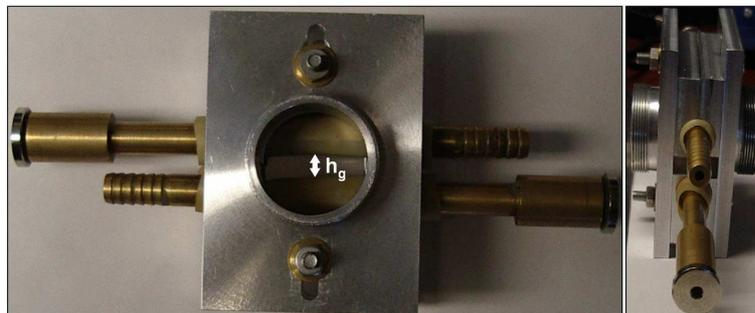
**FIGURE 3.5** – Photos de la maquette intégrant les répliques déformables de plis vocaux avec un écartement ajustable, décrite sur la figure 3.4. La position indiquée est celle à laquelle est mesurée la hauteur  $h_g$  par le système laser.
