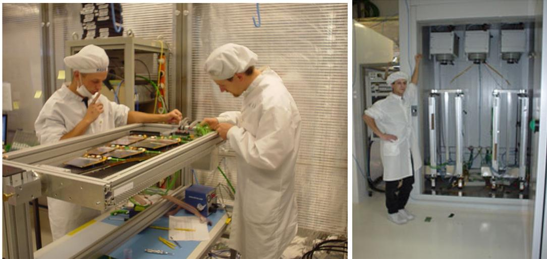
FIG. 3.5 – Photographies de techniciens en train d'assembler un pétale (à gauche) et du réfrigérateur utilisé pour les tests de qualification des pétales avec les cycles en température (à droite). Ces photographies proviennent du PIC CERN
