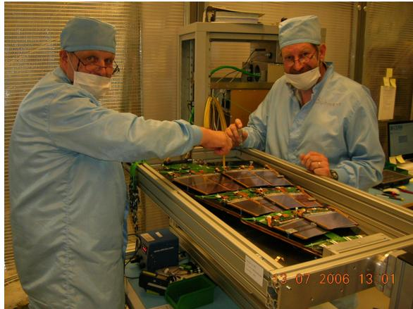
FIG. 3.9 – Opérateurs en train de vérifier les vis des modules lors de l'inspection optique d'un pétale
