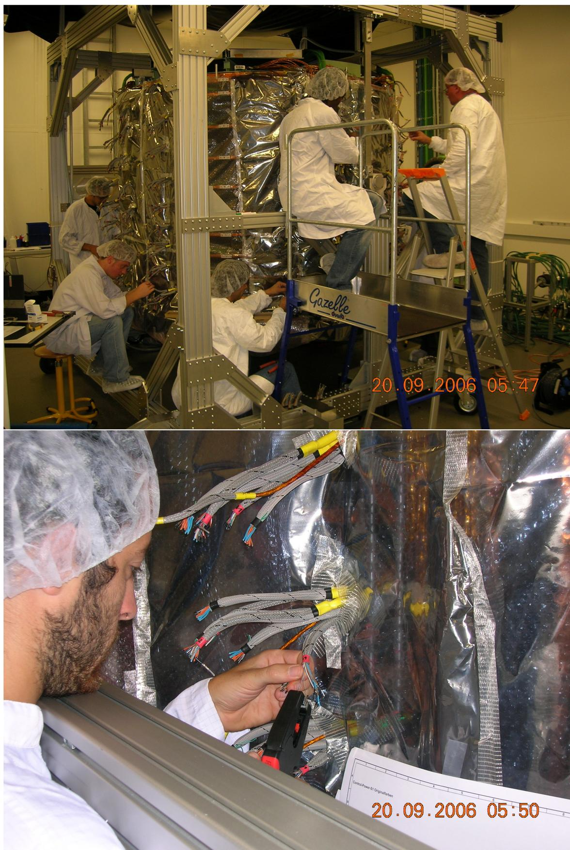
FIG. 3.29 – Techniciens en train d'effectuer le changement de connecteurs Mollex sur l'ensemble du bouchon .
