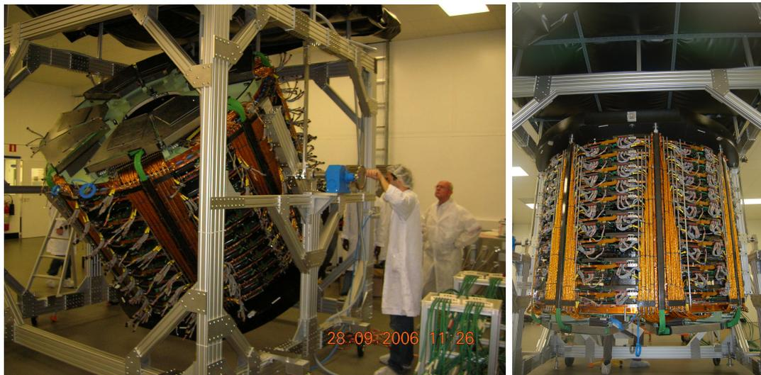
FIG. 3.14 – Rotation du bouchon via la manipulation du "cradle" par un technicien (à gauche). Secteurs intégrés et connectés du bouchon (à droite). Les services (en doré), les connexions électriques (en gris) et les fibres optiques (en vert) sont apparents.
