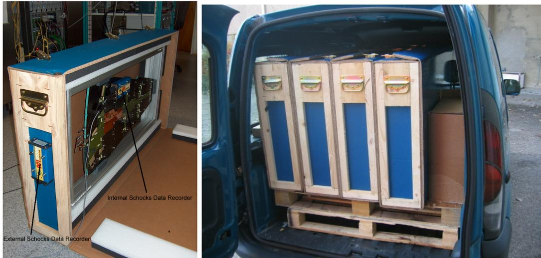
FIG. 3.8 – Photographies des mallettes utilisées pour le transport des pétales. À gauche, on aperçoit le pétale ainsi que deux senseurs de chocs, tandis qu'à droite on voit un exemple de transport de quatre pétales. Ils sont fixés à un cadre métallique et recouverts par des plaques de protection.
