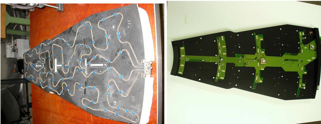
FIG. 3.3 – Photographies du circuit de refroidissement situé au sein du pétale (à gauche) et de l'ICB d'un pétale (à droite)
