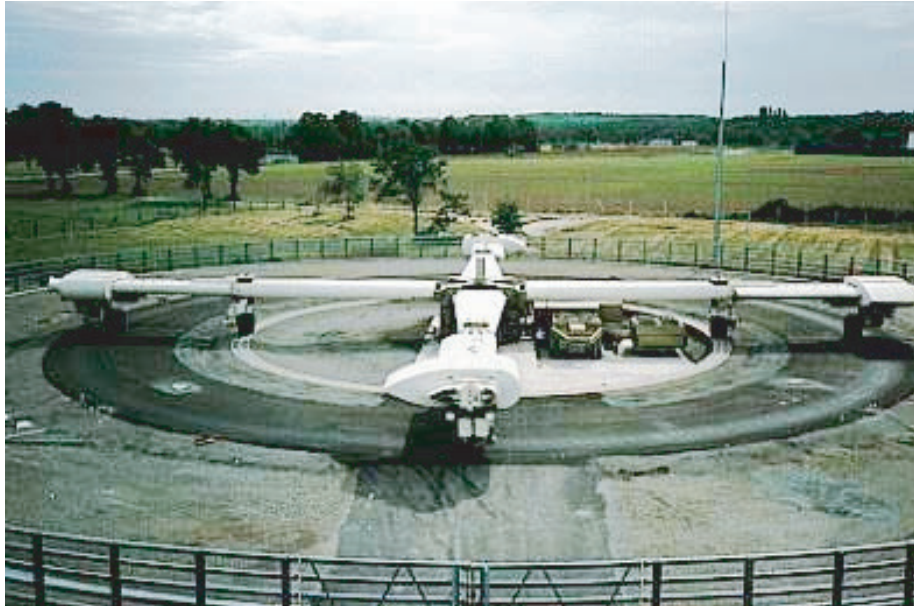
FIG. 1.3 – Manège de fatigue du Laboratoire Central des Ponts et Chaussées à Nantes
