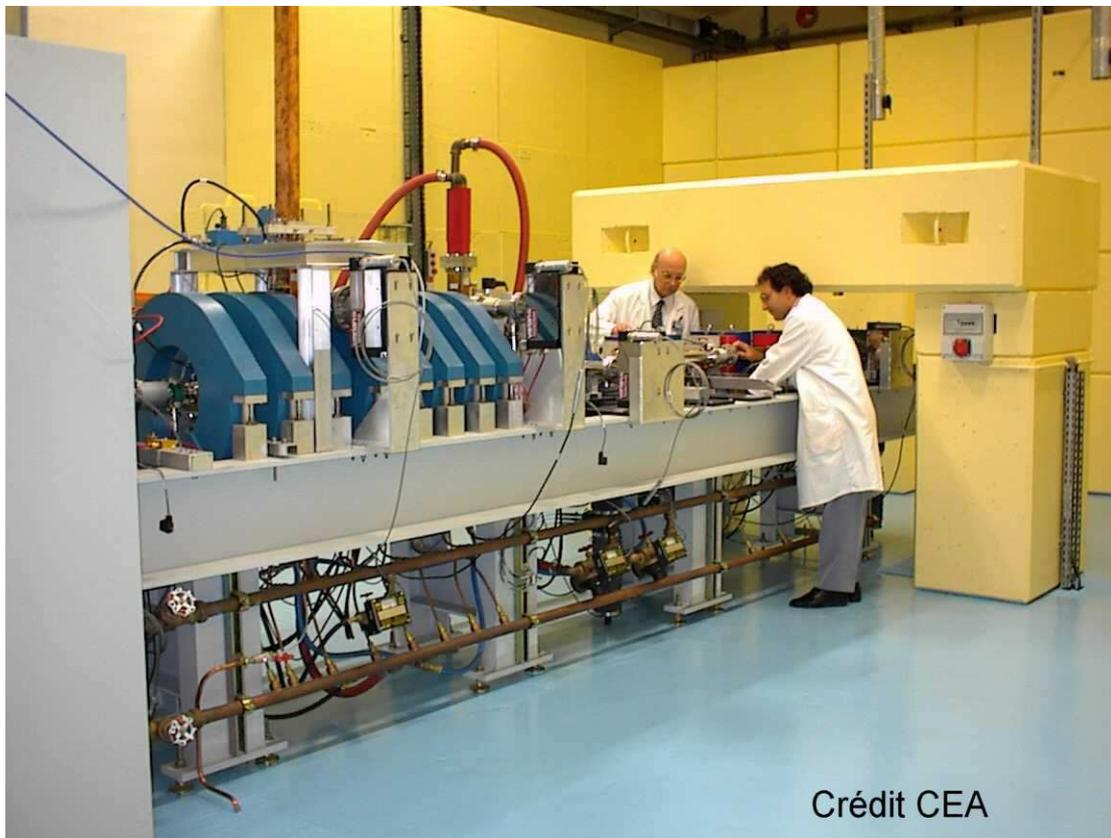
**Figure IV-6 Photo de l'accélérateur linéaire d'électrons (LINAC).**
