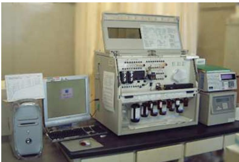
Figure IV-13 Séquenceur ABI 492 HT/ Procise d'Applied Biosystems (Foster City, CA, USA).
