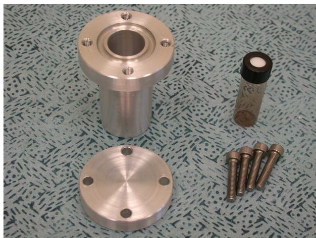
Figure IV-9 Photo de la jaquette de protection en aluminium et du flacon en verre de 4 mL fermé par un bouchon à vis et un septum, utilisés lors de l'irradiation.
