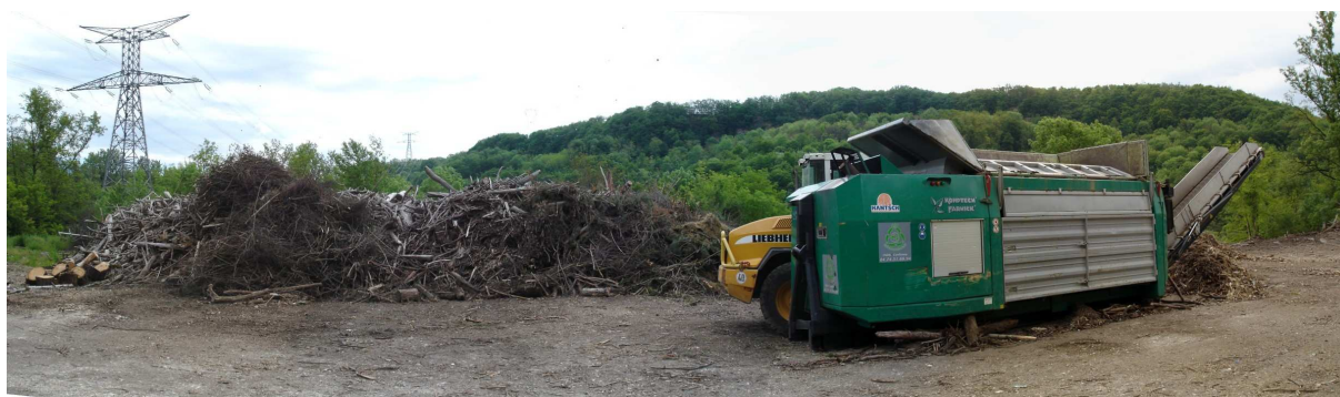
Photographie 6 – Le broyage des bois flottants au barrage de Génissiat (cliché : Moulin B., 2005).
