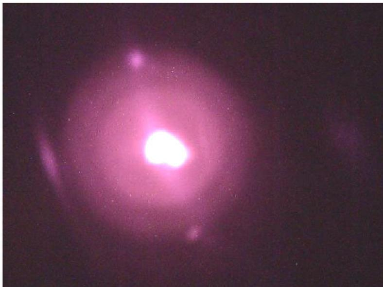
**Figure 6.8 : faisceau après réflexion sur le réseau résonnant.**
