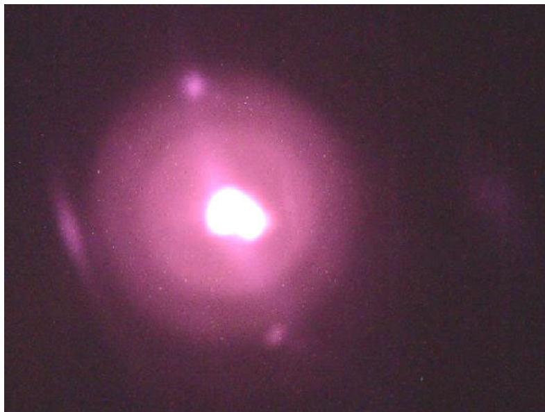
Figure 6.8 : faisceau après réflexion sur le réseau résonnant.
