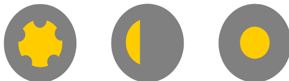
FIG. 5.32: Représentation schématique de l'évolution prévue pour l'icosaèdre d'ordre 11 (en coupe) dans le système Cu-Ag quand la concentration nominale augmente (ensemble canonique). En jaune, le cuivre et en gris l'argent. De la gauche vers la droite : configuration encapuchonnée ( 0 < c_{nom} < 0,4 ), configuration à calotte sphérique ( 0,4 < c_{nom} < 0,95 ), configuration coeur restreint/coquille étendue ( 0,95 < c_{nom} < 1 ).
