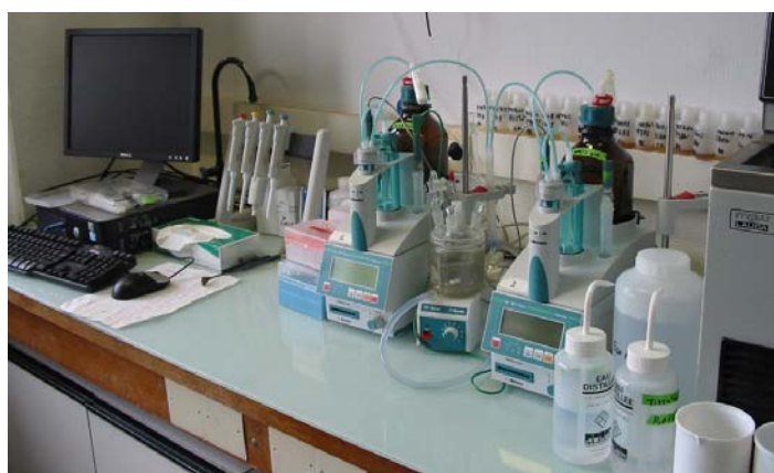
Figure 13 : Photographie du système de titration utilisé pour l'étude de la complexation du cuivre
