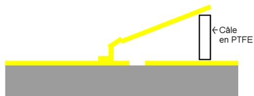
FIG. 4.20 – Réalisation schématique d'une antenne cornet TEM
