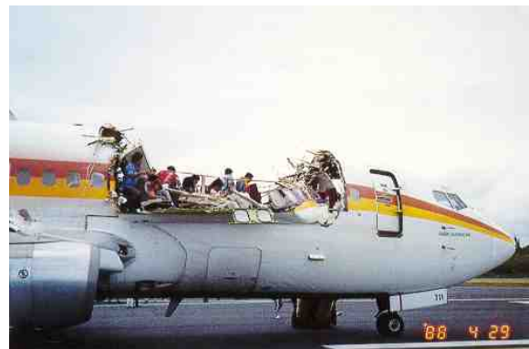
(b) Vol Aloha 243 après qu'une partie de son fuselage se soit arraché sous l'effet des vibrations causées par les turbulences et les atterrissages répétés (source : http://www.facstaff.bucknell.edu )
