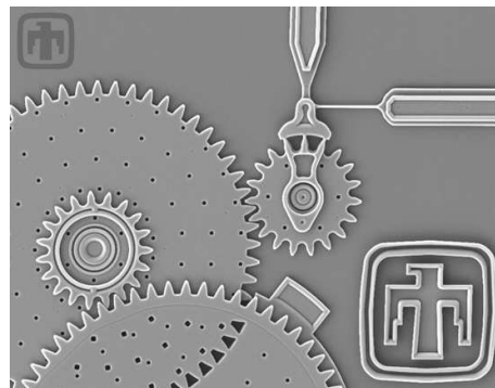
FIGURE 1.7 – Réducteur à engrenage 4 .
