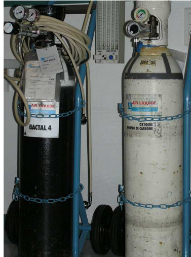
FIG. 8.1 – Bouteilles de gaz utilisées, à gauche la bouteille de Bactal, à droite la bouteille de carbogène. Chaque bouteille est équipée d'un manodétendeur. Sur le chariot du Bactal, est fixé le débitmètre pour l'air et l'oxygène.
