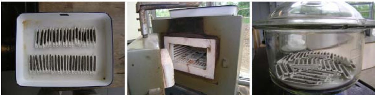
Figure 2.20 Photographies illustrant les différentes étapes des mesures de Perte Au Feu.
