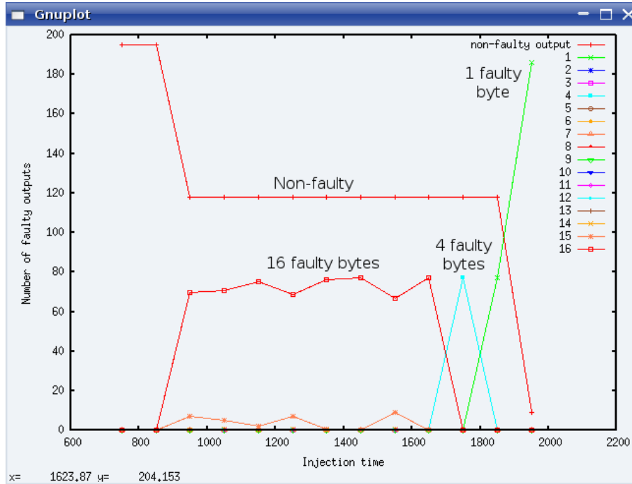
FIG. 4.8 – Octets fautés en sortie de l'AES (délai > 11 ns)
