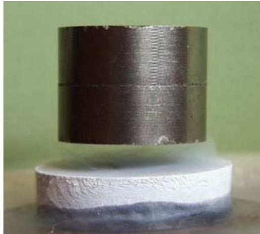
FIG. 1.3: Effet Meissner : phénomène de lévitation par répulsion magnétique .
