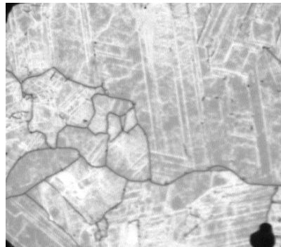
Figure VI-7. Cartographie de photocourant en lumière rouge ( \lambda > 750 \text{ nm} ) après deux étapes de « gettering » (diffusion P : 880°C - 1h + formation de l'alliage Al-Si: 880°C- 30 min).
