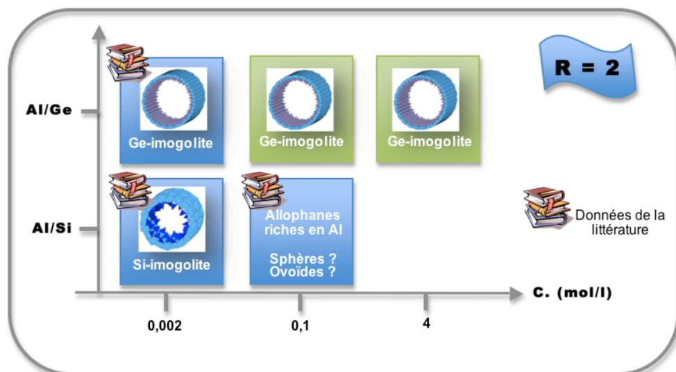
Figure 8. Bilan sur la synthèse d'aluminogermanates pour des concentrations de 0,002 à 4 mol.L<sup>-1</sup>.
