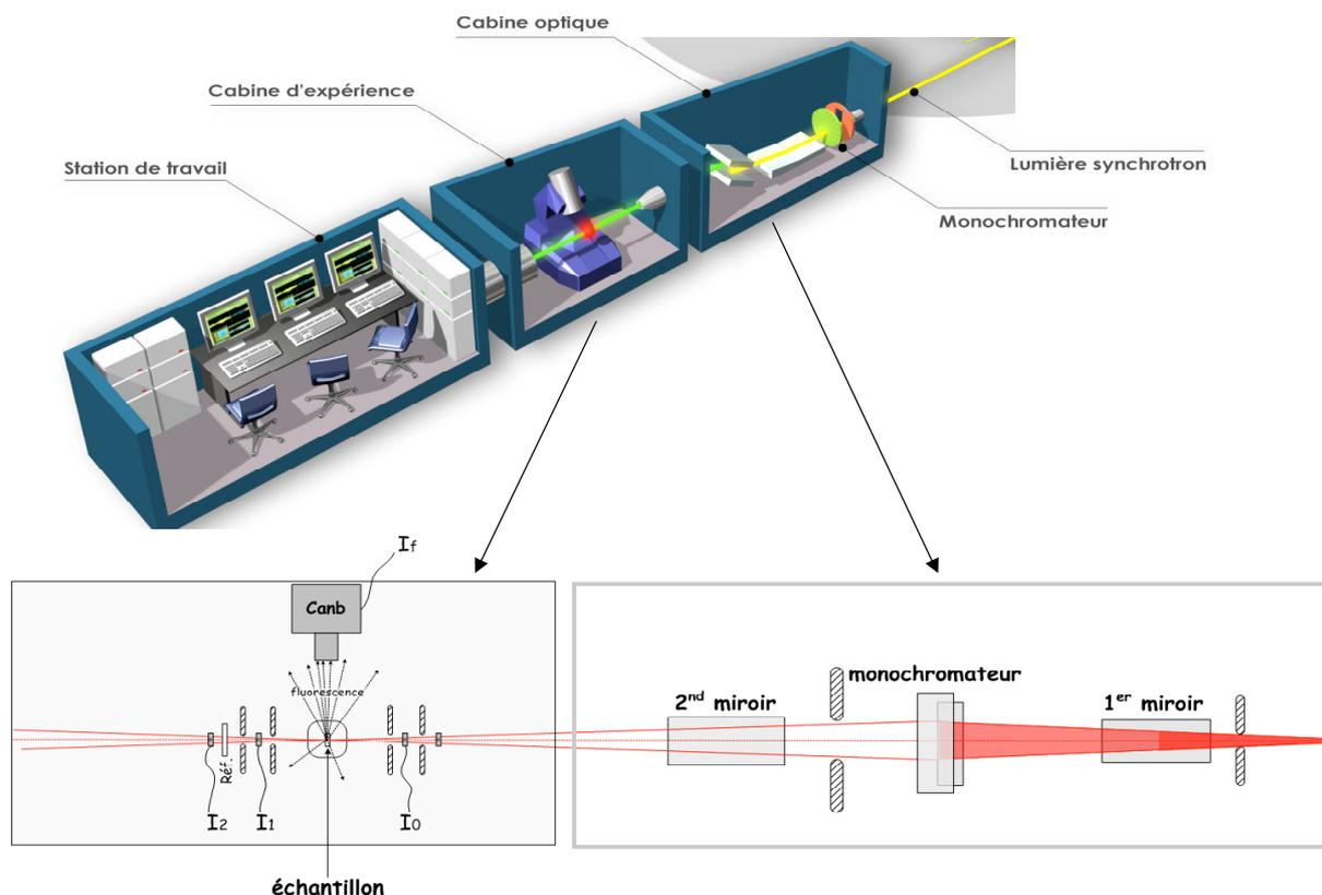
Figure 11. Schéma simplifié d'une ligne de lumière dédiée à la XAS (ex: du montage de la ligne FAME de l'ESRF) ([www.esrf.fr](http://www.esrf.fr) et [www.synchrotron-soleil.fr](http://www.synchrotron-soleil.fr)).
