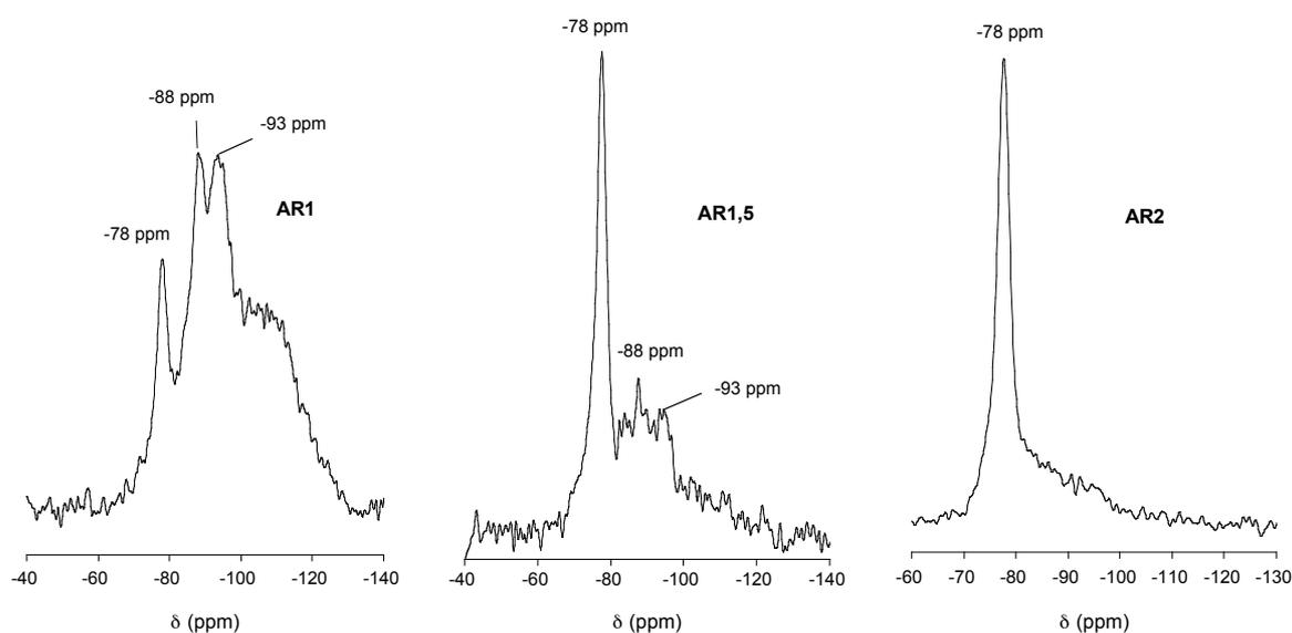
Figure 5. Spectres RMN<sup>29</sup>Si MAS des produits finaux dialysés AR1, AR1,5 et AR2.
