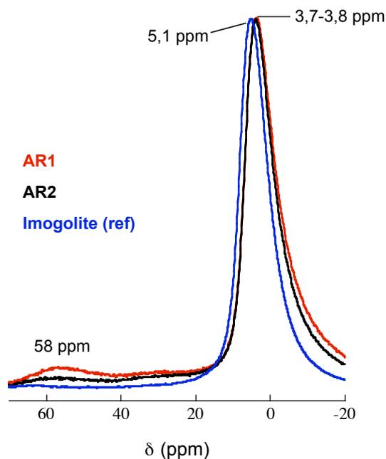
Figure 4. Spectres RMN  $^{27}\text{Al}$  MAS des produits finaux dialysés AR1 et AR2. Comparaison avec l'imogolite de référence.
