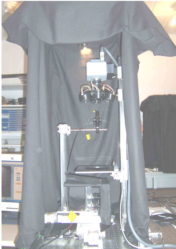
Figure 1.3. Photo et schéma du montage : positionnement de la souris entre le laser et la caméra.
