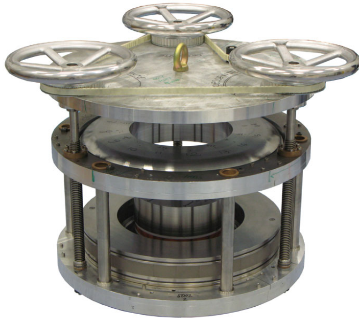
Figure 4.30: Machine d'assemblage du circuit magnétique.
