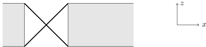
Figure 5.3: Deux lames croisées permettent de limiter le mouvement de la liaison à une rotation autour de y .
