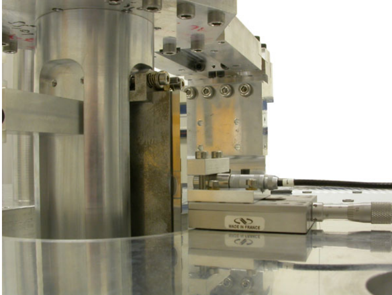
Figure 5.30: Système de mesure du défaut de rectitude du mouvement.
