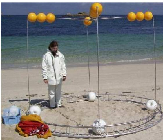
Figure 8 - Photo de la structure en inox servant de support aux microcosmes
