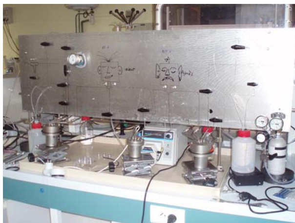
Figure 2.15: Photo du montage de remise en corrosion, vue de face.
