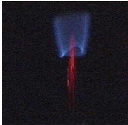
Figure 1-17 : Exemple de visualisation laser de l'écoulement de méthane dans le cas d'une flamme liftée.
