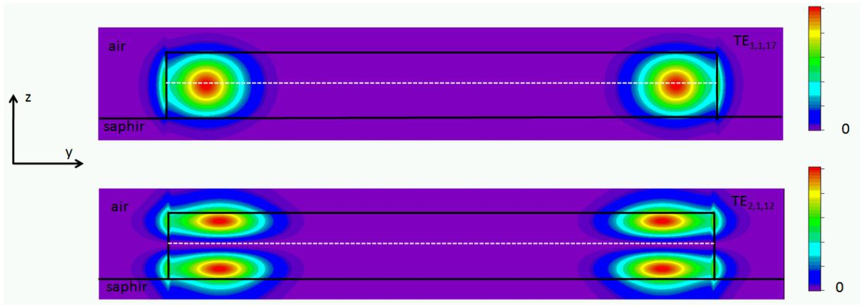
FIG. 3.15 – Profil de l'intensité du champ en coupe selon l'axe  $z$  pour deux modes  $TE_{1,1,m}$  et  $TE_{2,1,m'}$  d'un microdisque de  $2\mu m$  de diamètre reporté sur saphir. La position des plans de boîtes quantiques est indiquée par la ligne blanche pointillée. On voit ici que celle-ci correspond à un maximum du champ pour  $TE_1$ , tandis que c'est un minimum pour  $TE_2$ . La légère dissymétrie dans la structure du champ en  $z$  est plus visible pour le mode  $TE_{2,1,m}$
