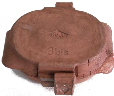
Figure 18 : exemple de moufle, on peut distinguer les clavettes qui solidarissent les 3 parties du moufle.
