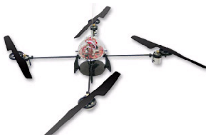
FIG. 1.17 – L'hélicoptère à quatre rotors "Draganfly III" de chez "Draganfly innovation, Inc" [29].
