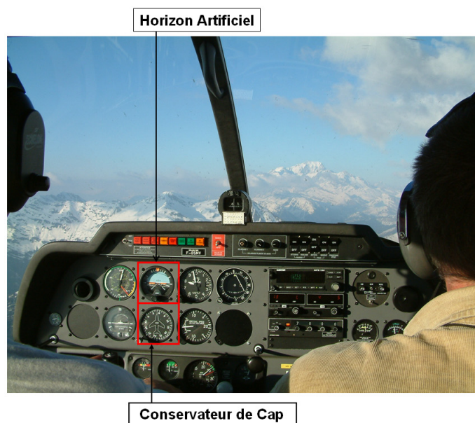
FIG. 1.6 – Le tableau de bord d'un avion de tourisme
