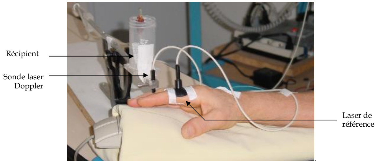
Figure 21 : Photographie du dispositif utilisé pour enregistrer la PIV sur le doigt.
